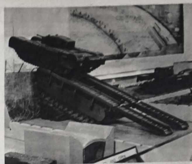
Ostatnio odbyła się w Londynie interesująca wystawa ilustrująca, jak dokonano dzieła inwazji na kontynent. Na naszym zdjęciu model czołgu mostu umożliwiającego przekroczenie broni pancernej przez słynny «niezdołany» wał zachodni Hitlera
