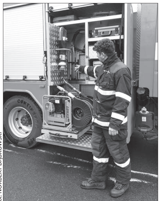
Strażak Marek Maceczek prezentuje sprzęt hydrauliczny służący do uwalniania ludzi z pojazdów podczas wypadków drogowych.
