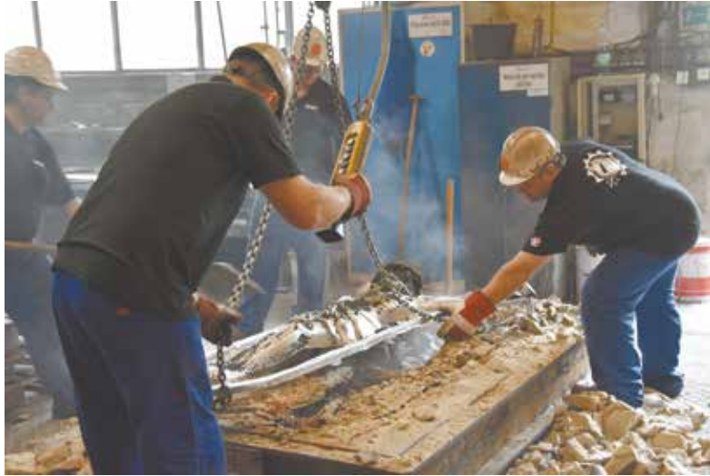
• Trzynieccy gisierzy wyjmują odlaną figurę Jezusa. Mierzy ona ponad 130 cm, waży ok. 50 kg. Fot. ARC
